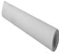
**Figura 7.** Tubo de Alúmina usado como barrera dieléctrica, sobre el cual se adapta el electrodo exterior
