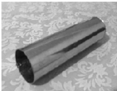
Figura 5. Pieza de acero inoxidable como electrodo externo
