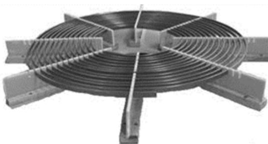
Figura 7. Bobina de baja tensión terminada
