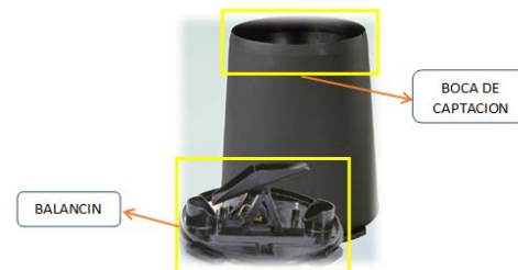
Fig. 2. Pluviómetro y sus partes.
