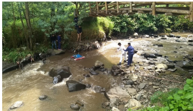
Figura 1. Aprendices e instructores del Centro Internacional de Producción Limpia LOPE, desarrollando la caracterización del potencial hídrico renovable en uno de los ríos de los cuales se obtuvo parámetros importantes en cuanto a identificación de caudal, profundidad y volumen.
