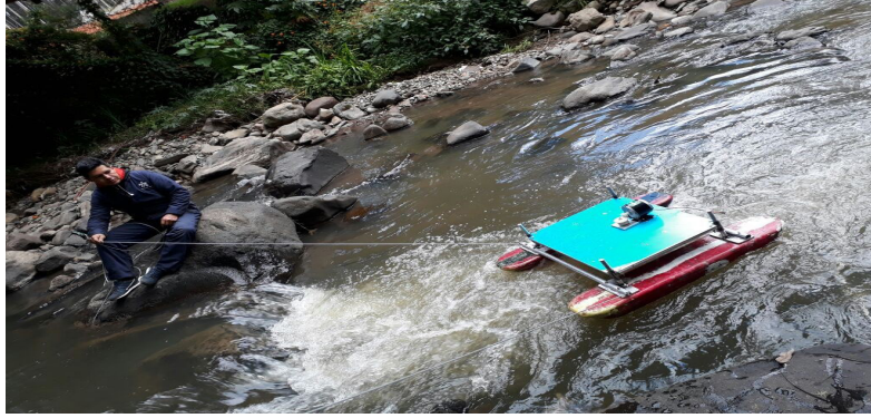
Figura 6. Desarrollo de pruebas de generación y almacenaje de energía en campo real del prototipo de generación de energía de la central mini-hidroeléctrica portable desarrollada por el equipo de CIPLL del SENA regional Nariño.
