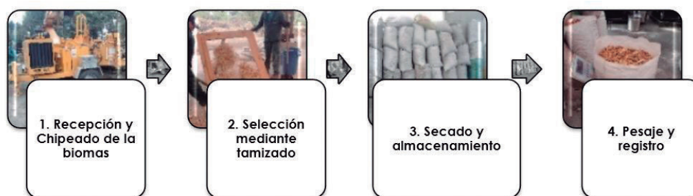
Figura 3. Acondicionamiento de la biomasa para proceso de gasificación Fuente: Los autores.
