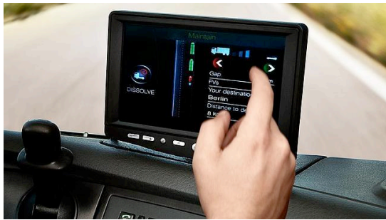
Figura 2. Pantalla que permite conocer el lugar de destino del camión líder, así como también el poder anclarse a él (Frigati, 2012)
