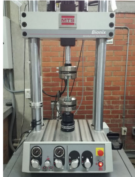
Figura 3. Máquina MTS Bionix usada para los ensayos.
