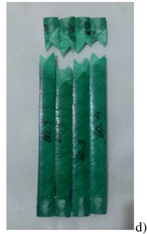
Figura 10. Probetas probadas al a) 90, b) 80, c) 70 y d) 60% del nivel de carga.
