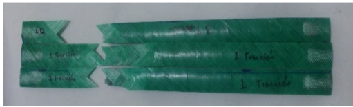
Figura 8. Probetas sometidas a carga estática.
