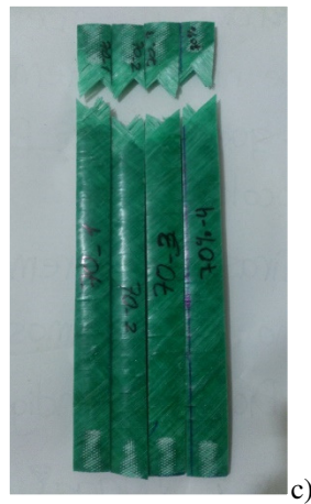
Figura 10. Probetas probadas al a) 90, b) 80, c) 70 y d) 60% del nivel de carga.
