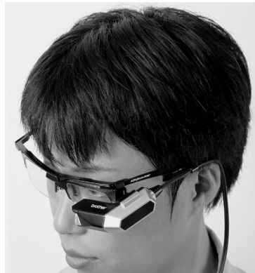
Proyección de información visual (textos e imágenes) sobre el cristal de las gafas, mediante el dispositivo AIRScouter.
