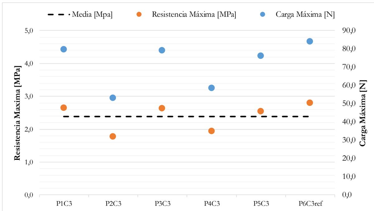
Figura 6. Grafica Carga vs Resistencia resultante del ensayo de compresión del bloque de concreto del sector Sangolqui.
