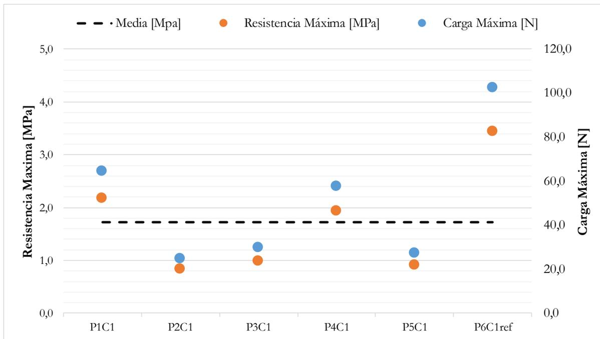
Figura 4. Grafica Carga vs Resistencia resultante del ensayo de compresión del bloque de concreto del sector de Amagüaña.
