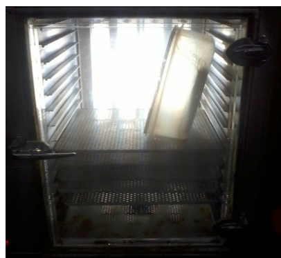
Figura 1. Cabina de germinación Seedburo con luz artificial y control analógico de la temperatura
