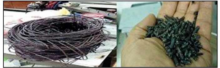
Figura 3. Material compuesto extruido y peletizado. Fotografía tomada por el equipo de investigación.
