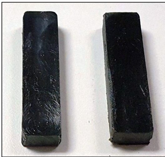
Figura 5. Probetas para la prueba de impacto. Fotografía tomada por el equipo de investigación.
