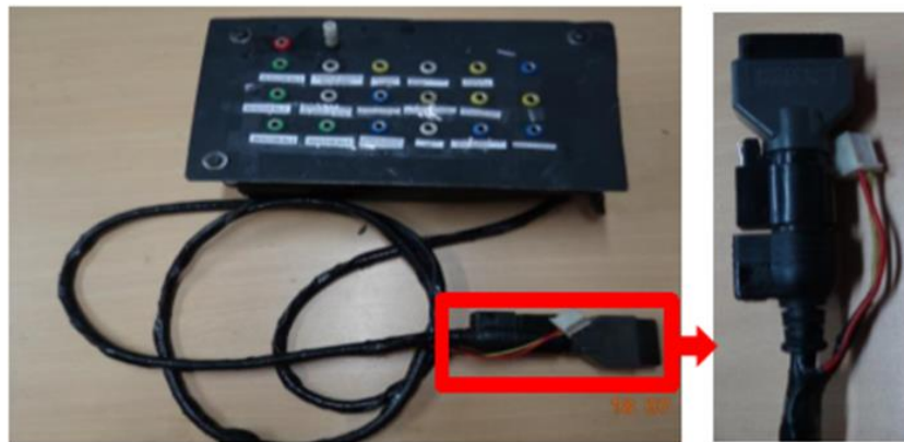
Figura 9. Caja de control para conexión del osciloscopio
