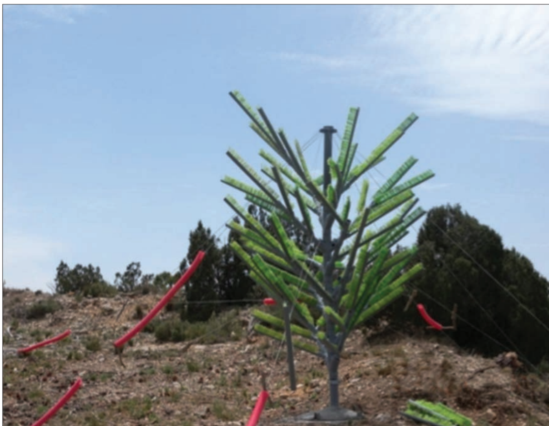
Figura 11. Imagen del método experimental de captación de agua proveniente de precipitación horizontal.
