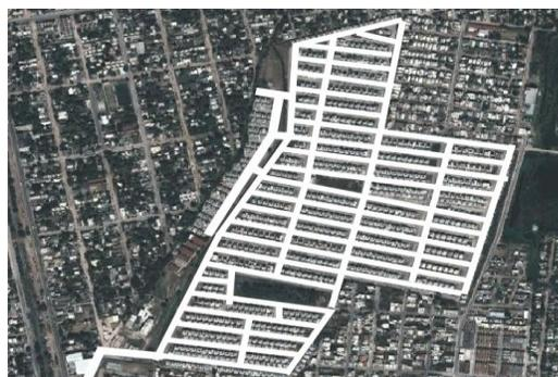
**Figura 5.** Traza reticular. 18 de Marzo. Madero, Long. Vial: 11892 m. Ancho de calle: 10m, carriles: 2. Sup.vial: 118920 m2
