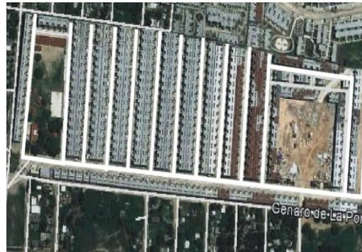
**Figura 3.** Traza de peine. Los Mangos, Altamira. Long. vial: 3035 m. Ancho calle: 10 m. carriles: 2, Sup. vial: 30350 m<sup>2</sup>
