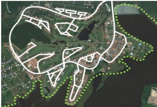
**Figura 2.** Traza orgánica. Lagunas de Miralta. Altamira. Long. vial: 17338 m. Ancho calle: 12 m., carriles: 2. Sup. vial: 208, 05 m<sup>2</sup>
