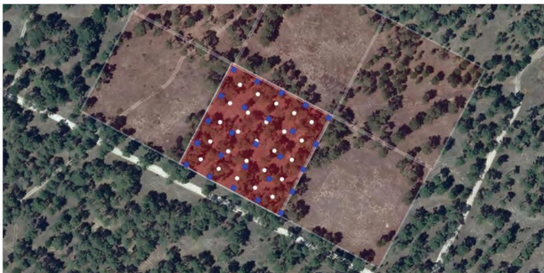
**Figura 1.** Ejemplo de colocaci3n de los barridos y los puntos de enlace llevado a cabo en cada parcela. Los puntos blancos representan las esferas y los cuadrados azules las posiciones de escaneo.
