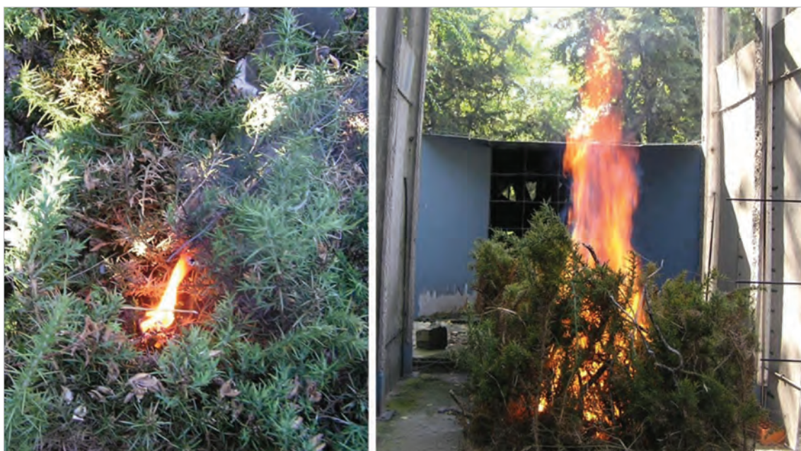
Figura 2. Ensayo de riesgo de inicio de incendio en matorral, con detalle de la pavesa inflamada empleada como foco de ignición puntual.
