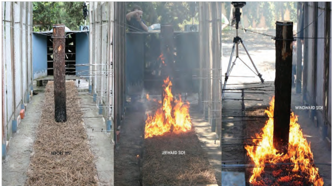
Figura 4. Ensayo de comportamiento del fuego de hojarasca e interacción con tronco. Se muestra la disposición antes del ensayo, la vista frontal con el efecto de la turbulencia de la llama a sotavento y la vista posterior con la interacción llama-tronco a barlovento (velocidad del viento 1 \text{ m s}^{-1} ). Más detalles en Madrigal et al. , 2011.
