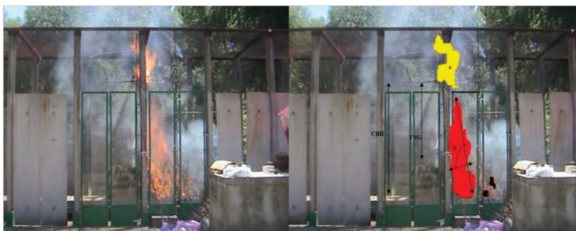
Figura 5. Túnel de Viento del INIA en vista lateral donde se muestra la geometría y avance de la llama analizados con el programa ImageTool®. En rojo, la geometría de la llama procedente del fuego de superficie y en amarillo la generada en la copa. Se muestran los valores de longitud de eje mayor y menor de la llama, ángulo de llama ( \alpha ) y los valores considerados para las variables CBH (altura de la primera rama viva) y FSG (discontinuidad entre matorral y copa).
