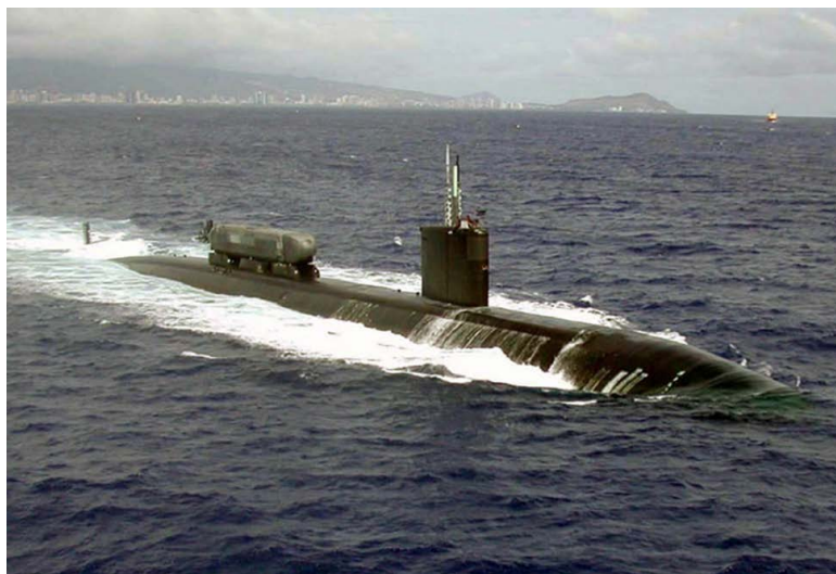
Figura 1. USS Greenville con un sistema de operaciones especiales (USN)
