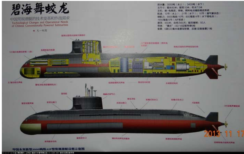
Figura 4. Información sobre la planta AIP en los submarinos chinos
