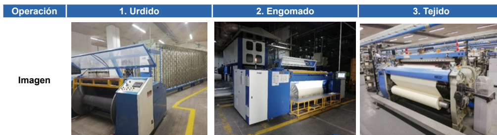
Figura 3. Operaciones básicas para la elaboración de la tela. Operación 1) Urdido, operación 2) Engomado, operación 3) Tejido. Fuente: elaboración propia basado en el manual de funcionamiento.
