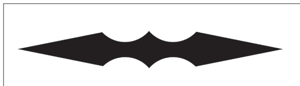
Fig. 6: Modelo esquemático (no a escala) de la sección de la hoja, donde se aprecian los dos vaceos y las tres "falsas aristas" resultantes.
