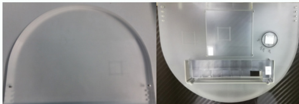
Figura 3a. Pieza de PMMA, fantoma Normi Mam, modelo disponible en el HSJD. Fuente de elaboración propia.
