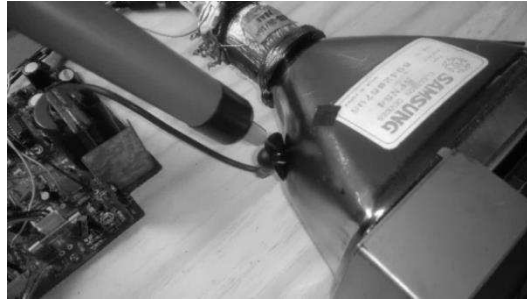
Fig. 13 – Medição da alta tensão. Fonte: acervo dos autores.
