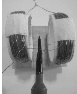
Fig. 16 – Medição do campo magnético no interior da bobina. Fonte: acervo dos autores.
