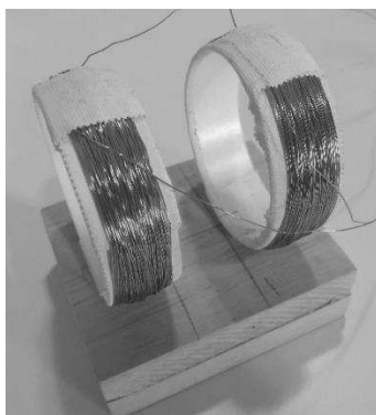
Fig. 10 – Bobina de Helmholtz construída para o experimento. Fonte: acervo dos autores.
