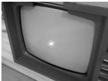
Fig. 8 – Preparação do BDS e/m apparatus: um ponto luminoso. Fonte: acervo dos autores.
