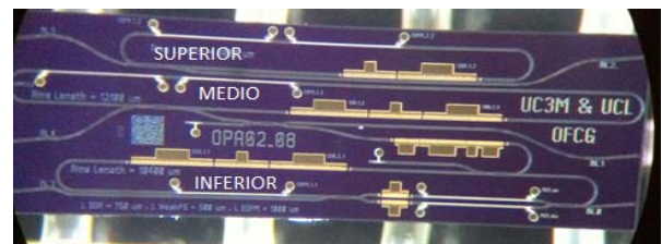
Fig. 2. Fotografía del PIC, generador de peine de frecuencias ópticas, que muestra los tres anillos: superior, medio e inferior.
