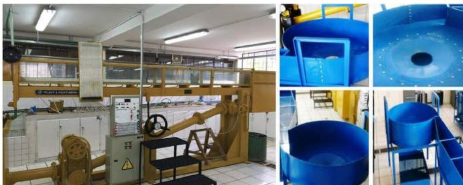
Figura 1. Fotografías del banco (canal) y vórtice rotacional hidráulicos (Laboratorio de Hidráulica, Universidad Técnica Particular de Loja-Ecuador).
