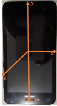
Figura 7. Distribución de coordenadas cartesianas en un smartphone
