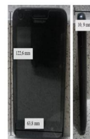
Figura 3. Smartphone Huawei Y360, con dimensiones de 122,6 mm x 63,8 mm x 10,9 mm y 120 gr.
