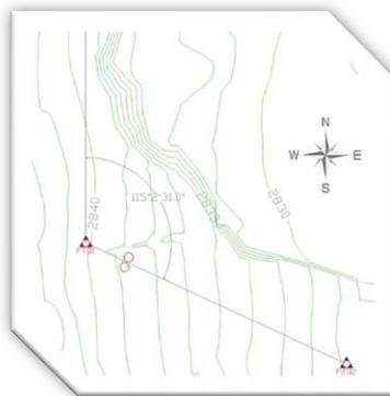
**Figura 5.** Determinación Azimut Alineamiento de “Los Cojines del Zaque”. Fuente: Elaboración propia de los autores.
