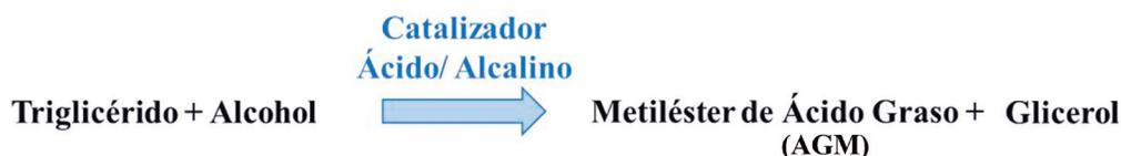
Figura 1. Reacción del proceso de Transesterificación
