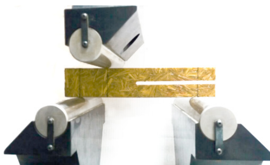
Fig. 4. Montaje para ensayo de fractura en modo II. Fuente: Autores.
