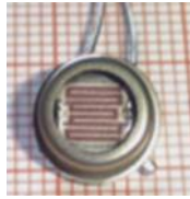
Fig. 5. Muestra real de los fotoresistores.
