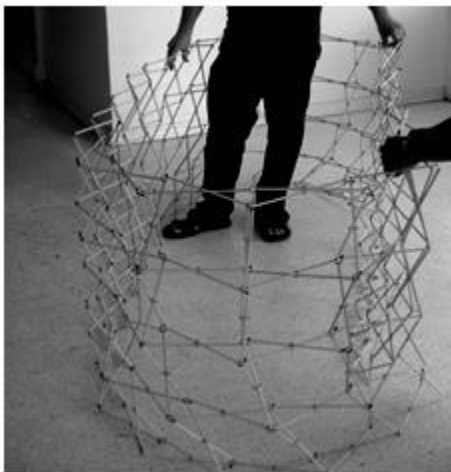
Figura 6. Modelo a escala de una estructura retráctil: a) estructura plegada, b) estructura desplegada
