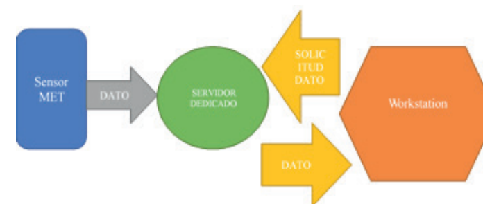
Figura 19. Comunicación Workstation & Sensor
