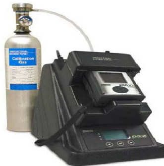
Fig. 1. Medidor de Compuestos Orgánicos Volátiles IBRID MX 6
