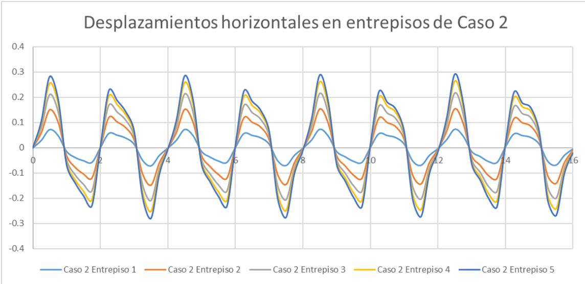
Fig. 6. Desplazamientos generados en el tiempo para el caso 2, tiempo (abscisas, segundos), Desplazamientos (ordenadas, metros).
