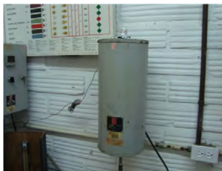
Fig. 1: Horno vertical para la carbonización. Propiedad de la Universidad Pontificia Bolivariana de Medellín
