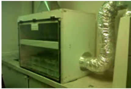
Fig. 3: Sistema estático e isotérmico que contiene las cajas con las sales
