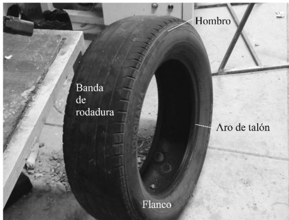
Figura 1. Partes principales de un neumático.
