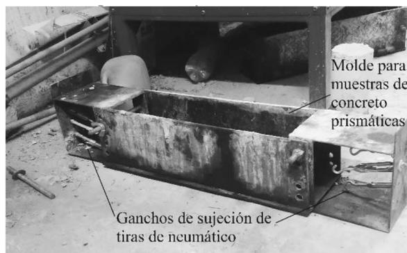
**Figura 9.** Molde para sujetar y ubicar tiras de neumático en muestras prismáticas de concreto.
