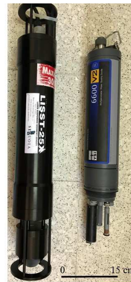
Figura 3. Sonda YSI 6600 a la derecha y sonda LISST-25X a la izquierda de la imagen
