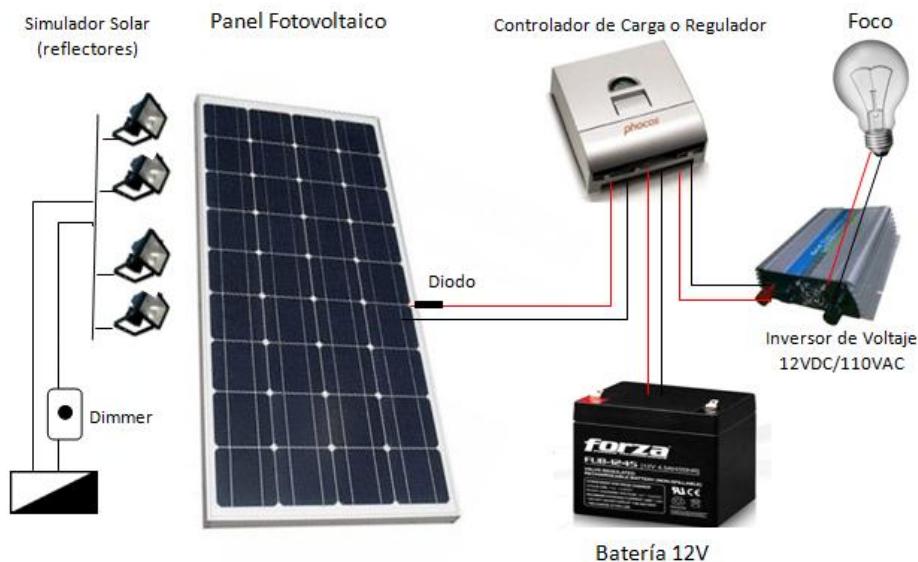
Figura1. Esquema Gráfico del Montaje de los elementos que componen el Simulador Fotovoltaico
