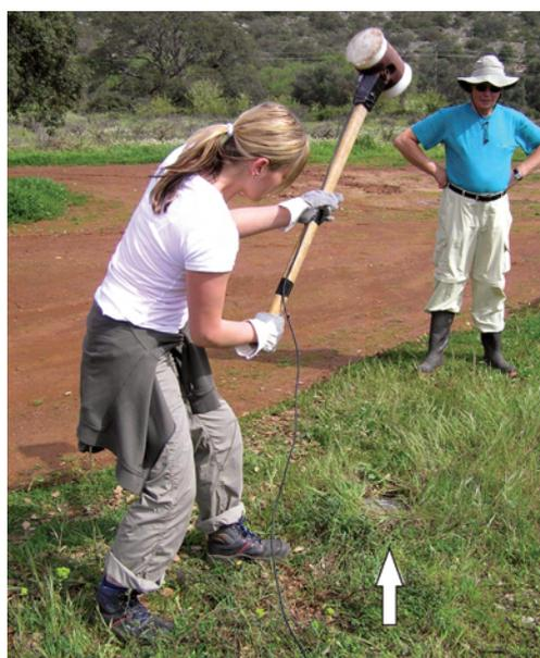
Fig. 9 – Prospecção geofísica baseada na aplicação de sísmica de refacção, utilizada durante o projecto para criar perfis geológicos do subsolo, nos diferentes paleo-estuários em estudo.
