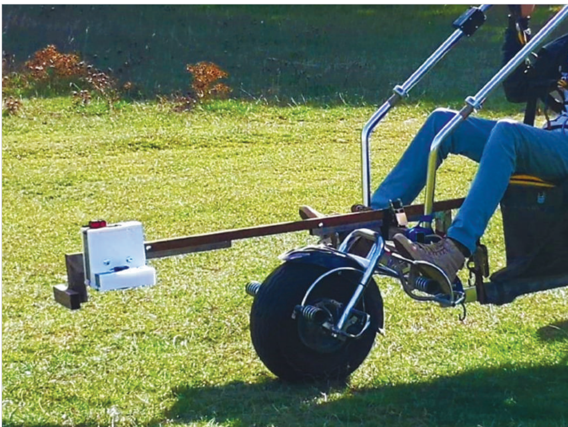
Figura 7. Detalle de integración del sistema sensores al chasis de la plataforma aérea.
