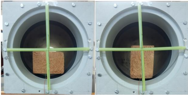
FIGURA 18. Visão frontal do tubo com o um anteparo colocado no seu interior em duas posições distintas (Acervo do autor).
