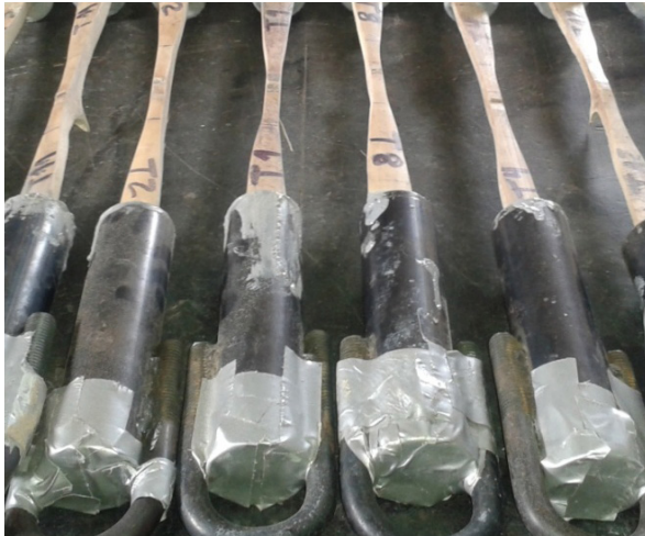
Figura 4. Muestras de tiras de caña guadua con una reducción de su área en el centro para el ensayo de tracción. Fuente: Córdova. P. (2014). Obtención de las Propiedades mecánicas y estructurales de la caña guadua Angustifolia Kunth del Ecuador.
