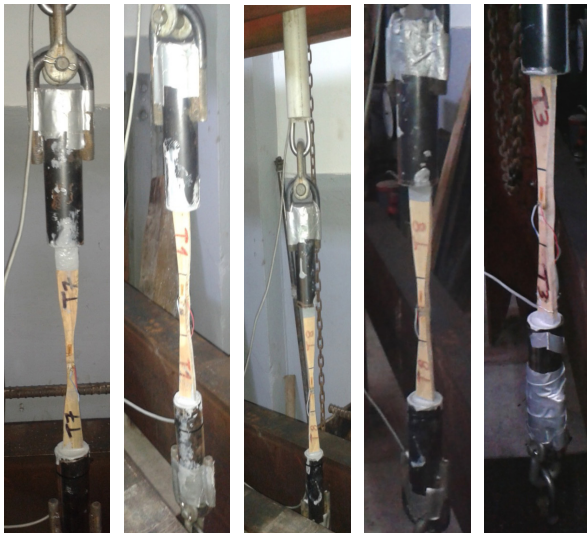
Figura 6. Ensayo de tracción paralela a la fibra. Fuente: Córdova. P. (2014). Obtención de las Propiedades mecánicas y estructurales de la caña guadua Angustifolia Kunth del Ecuador.
