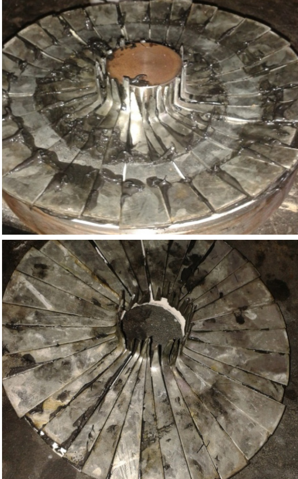
Figura 2. Placa elaborada para el ensayo de compresión libre de fricción en la muestra. que permite el deslizamiento horizontal. Fuente: Córdova. P. 2014. Obtención de las Propiedades mecánicas y estructurales de la caña guadua Angustifolia Kunth del Ecuador.
