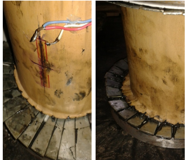
Figura 3. Muestras ensayadas a compresión simple. Fuente: Córdova. P. (2014). Obtención de las propiedades mecánicas y estructurales de la caña guadua Angustifolia Kunth del Ecuador
