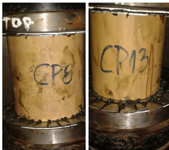
Figura 1. Ensayo de compresión simple paralela a la fibra. Fuente: Córdova. P. 2014. Obtención de las Propiedades mecánicas y estructurales de la caña guadua Angustifolia Kunth del Ecuador.
