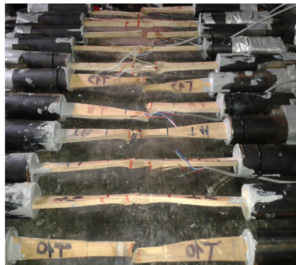
Figura 7. Mecanismo de falla de muestras de caña guadua a tracción. Fuente: Córdova. P. (2014). Obtención de las Propiedades mecánicas y estructurales de la caña guadua Angustifolia Kunth del Ecuador.
