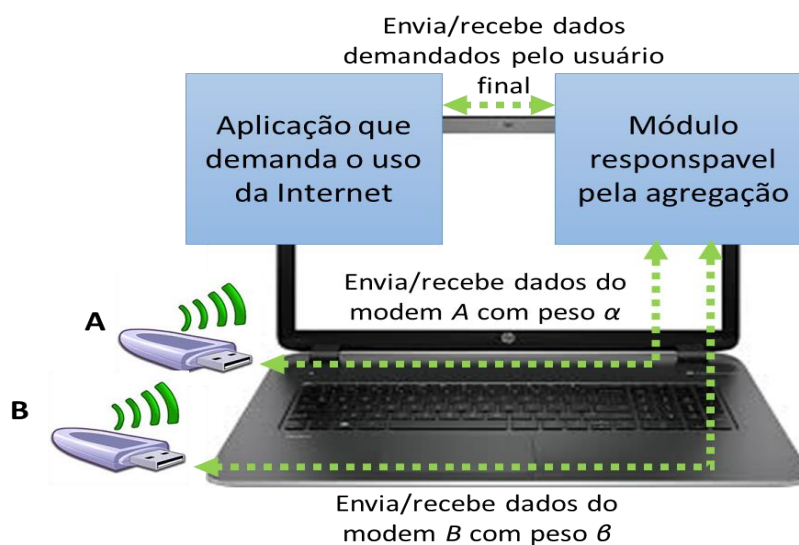
Figura 1: Representação esquemática da proposta para avaliação de agregação de enlaces móveis.
