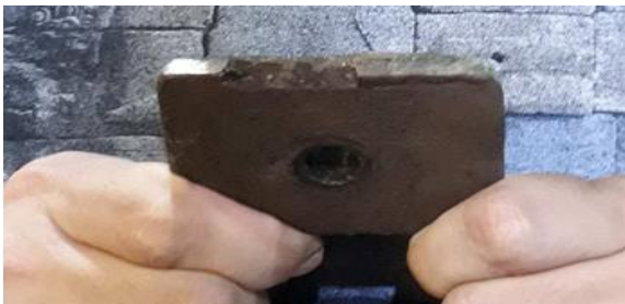
Fig. 13. Desperfecto en dado de extrusión.
