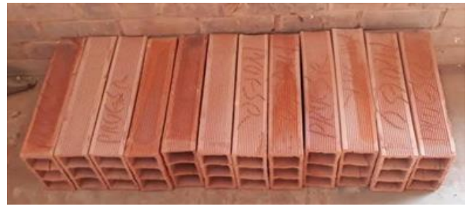
Fig. 9. Bloques con bajo contenido de arcilla.
