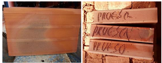
Fig. 11. Bloques con bajo contenido de arena.
