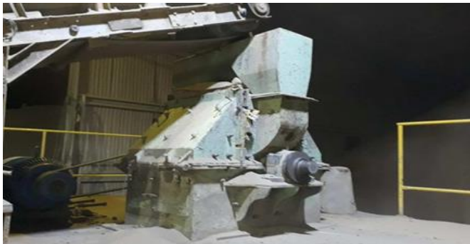
Fig. 4. Molino tipo martillo de la planta Gres Caribe S.A.
