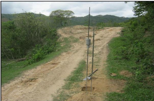
Figura 4. Realización de ensayos con Penetrómetro dinámico de cono. Fuente: Autores
