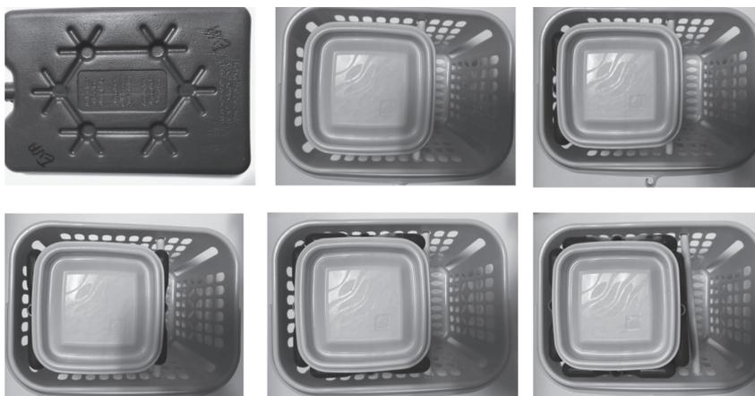
Figura 11. Bloque refrigerante utilizado y detalle de la colocación de los sistemas de refrigeración en el interior de la nevera de transporte (fila de arriba: 0 bloques en el centro y 1 bloque a la derecha; fila de abajo y de izquierda a derecha: 2 bloques, 3 bloques, 4 bloques).
