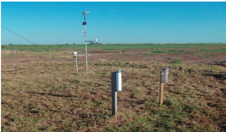
Figura 2. El atmómetro se instaló junto a una estación meteorológica automática.
