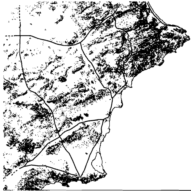
FIGURA 2. Corredores de comunicación potencial. En trama oscura aparecen las zonas con desniveles superiores al 18% que constituyen áreas de tránsito muy dificultoso y no apto para carruajes. En trama gris, vías de comunicación potencial.
