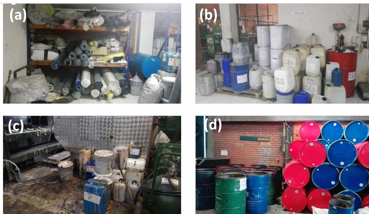
Figura 4. Almacenamiento de insumos y sustancias químicas: (a) Almacén – rollos de tela, plástico al lado de sustancias químicas, (b) Almacén – Pinturas y polirol sin estibar ni etiquetar, (c) Cabina de pinturas – sin etiquetas y (d) Zona de disposición final – Tinas desocupadas con tinas llenas de sustancias químicas.
