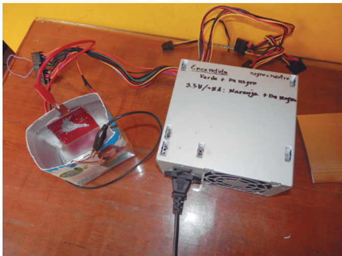
Imagen 2. Sistema de electrólisis con una fuente de poder de PC y un recipiente tetra-brik . El polo positivo está conectado a una maraña de cables de cobre y el positivo a la placa para grabado. El electrolito usado es sal al 25%.
