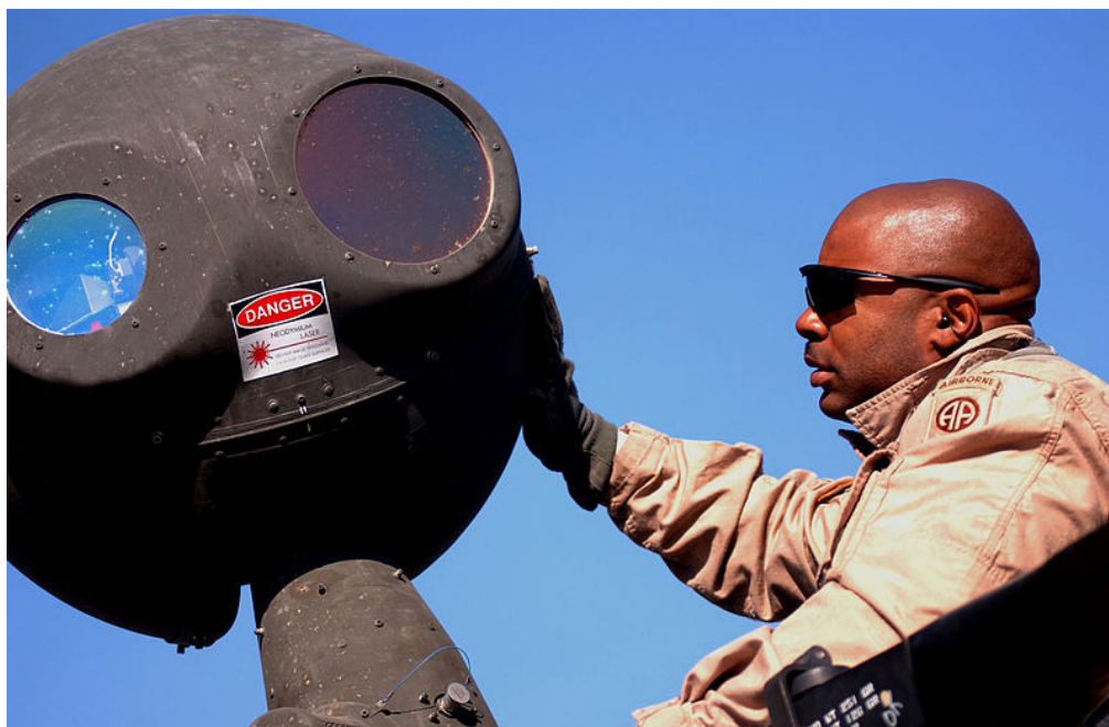
Figura 3: Inspección de un sensor térmico montado en un helicóptero OH-58D Kiowa Warrior.
