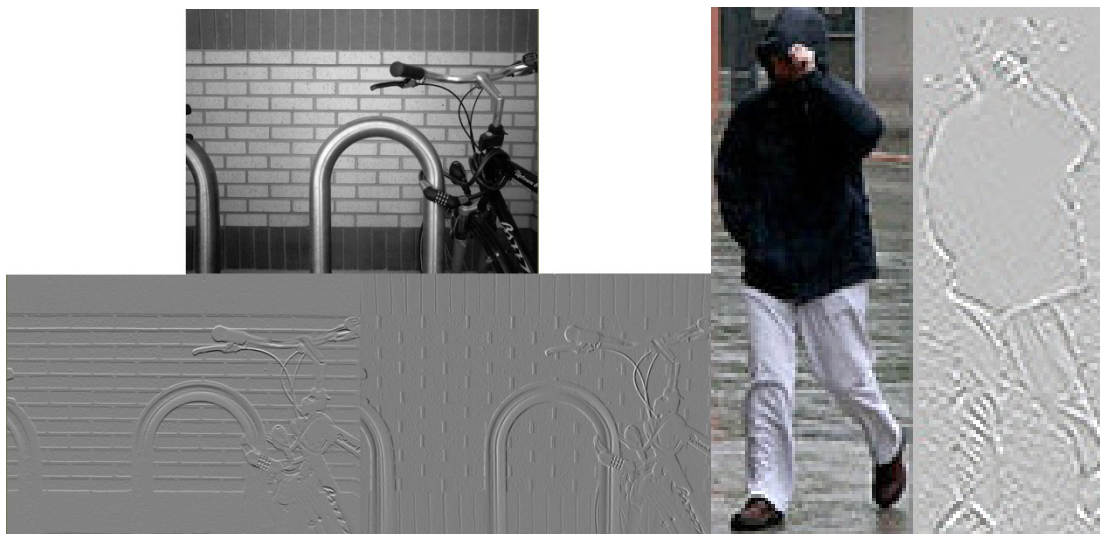
Figura 9: Ejemplos del pre-procesamiento mediante técnicas de detección de bordes.
