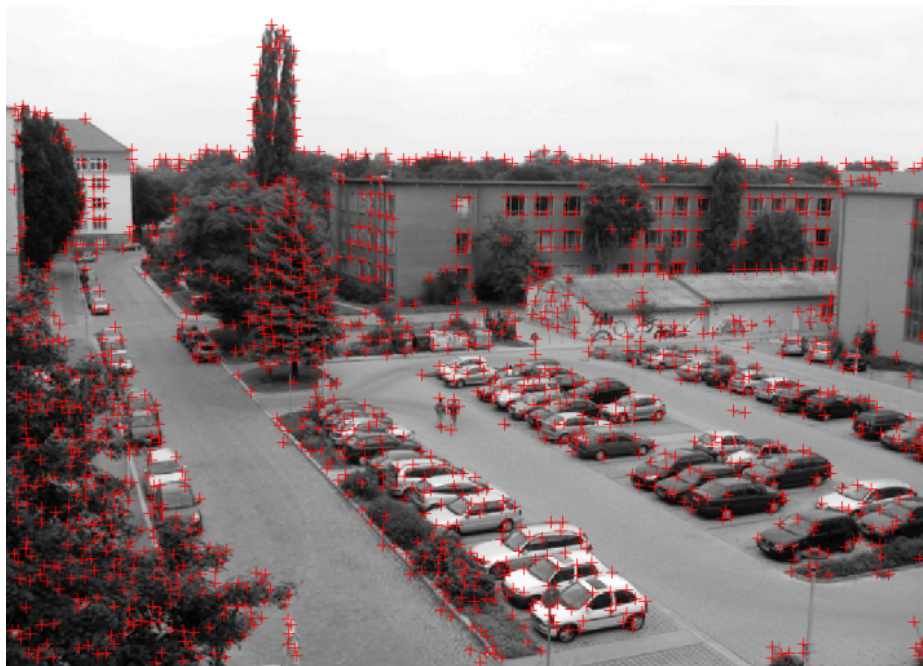
Figura 10: ejemplo del resultado de una segmentación, identificando los puntos de interés.
