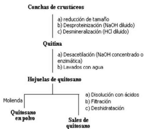
Fig. 1. Proceso de extracción de quitina y quitosano.
