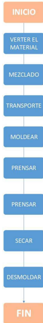
Figura 6: Diagrama de proceso para la aglomeración y compactación.
