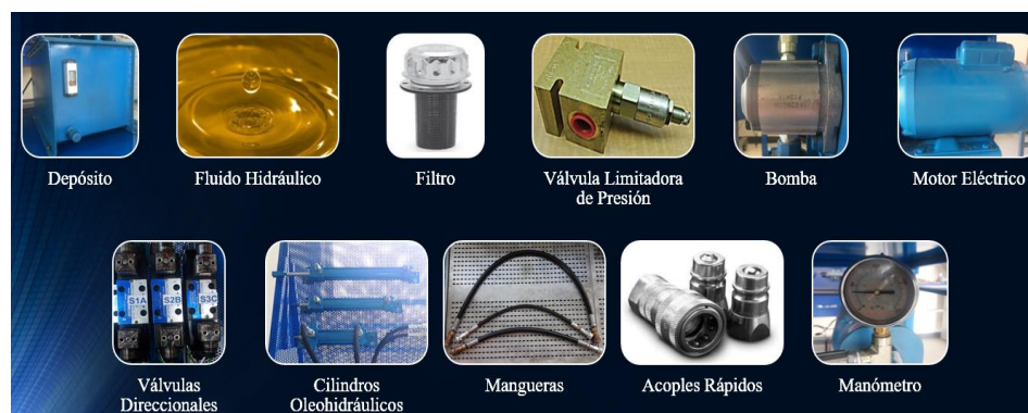
Fig. 3 Elementos del circuito oleo-hidráulico
